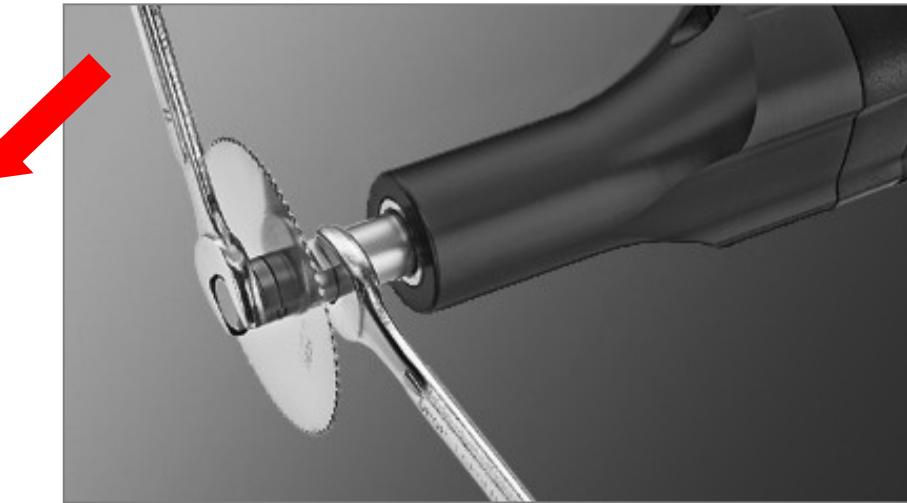
figura 3 Svitare la vite di fissaggio
