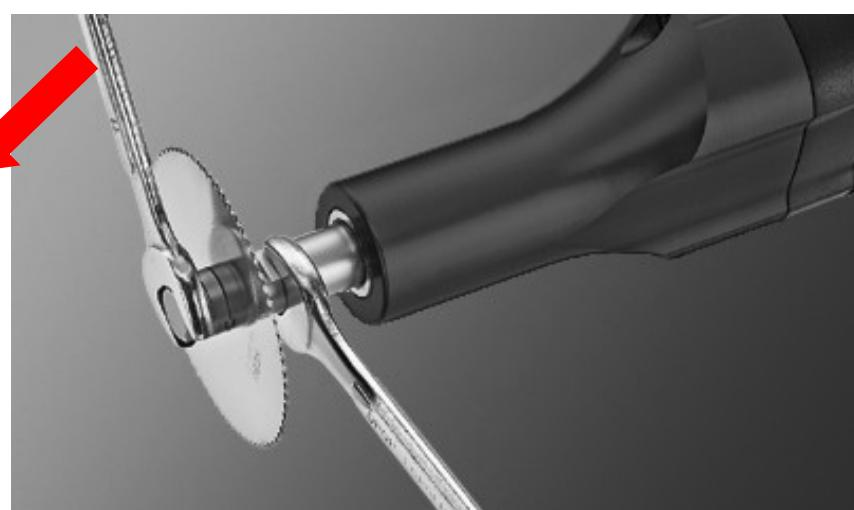
Ilustración 3 Soltado del tornillo de sujeción
