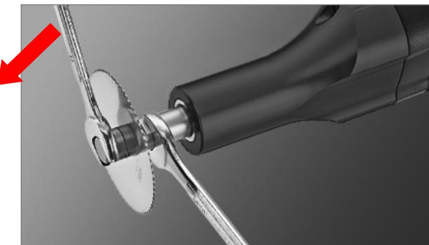
Abbildung 3 Lösen der Halteschraube
