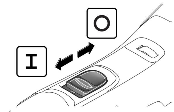
figure 5 Mise en marche / Arrêt
