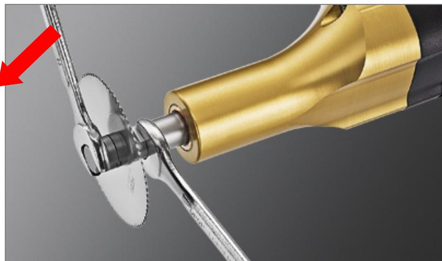
Abbildung 3 Lösen der halteschraube
