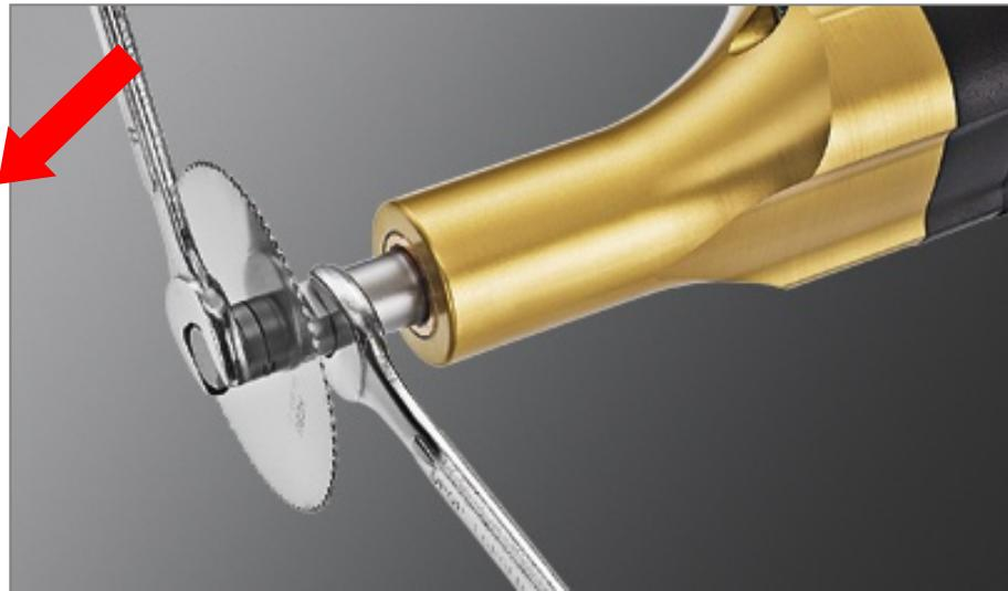
figure 3 Desserrer la vis de maintien
