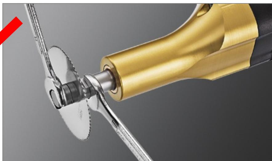
Abbildung 3 Lösen der Halteschraube
