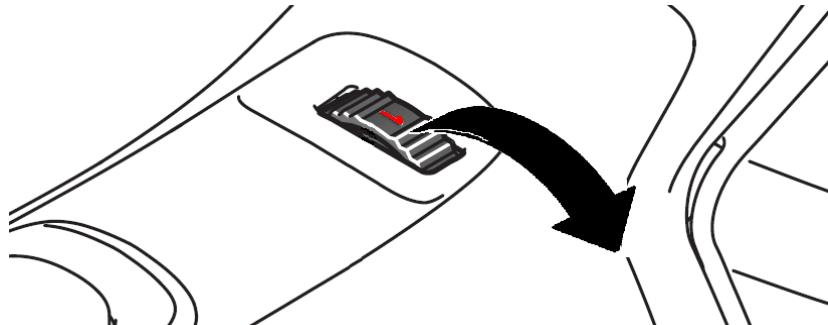
Abbildung 6 Schwingfrequenz einstellen
