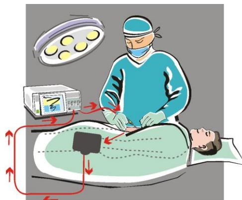
La corriente AF fluye del electrodo activo al electrodo neutro y se distribuye en su gran superficie. De esta forma se reduce en ese punto la densidad de la corriente y, por regla general, no se producen efectos térmicos inesperados en la posición del electrodo neutro. La corriente retorna al instrumento electroquirúrgico a través del electrodo neutro.
