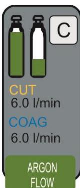
La corriente de gas puede ajustarse en un intervalo de 0,1 L/min a 6,0 L/min en pasos de 0,1 L/min.
