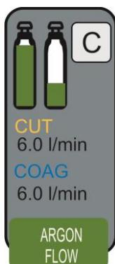
Il est possible de régler le flux de gaz dans un intervalle de 0,1 l/min à 6,0 l/min par pas de 0,1 l/min.
