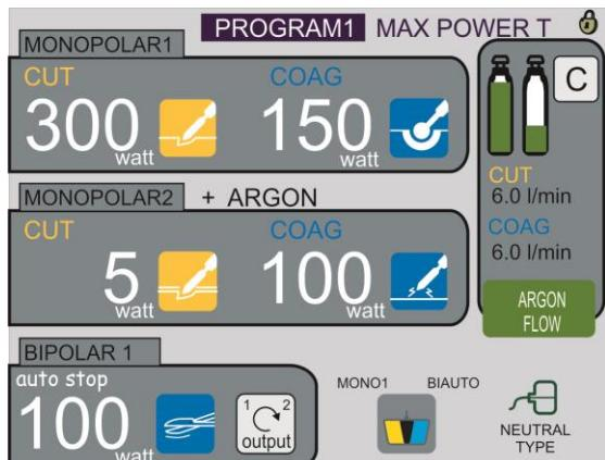
Per attivare la funzione argon tocca „Argon Flow“ nel menu principale. Con questo apparisce „+ Argon“ nel indicatore che garantisce la attivazione della funzione (vedi figura a sinistra).
