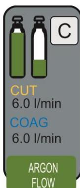
La portata di gas può essere regolata da 0,1 L/min a 6,0 L/min ad intervalli di 0,1 L/min.
