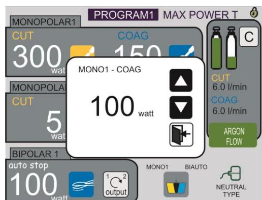
Pour régler la puissance désirée, utiliser les touches à flèche.
