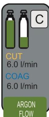
Der Gasstrom kann in einem Intervall von 0,1 L/min bis 6,0 L/min in Schritten von 0,1 l/min eingestellt werden.
