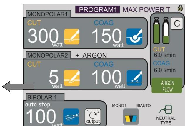
Para activar la función de argón toque el "Argon Flow" en el menú principal. Al parecer "\*argon" en la pantalla, lo que garantiza la activación de esta función (ver a la izquierda)
